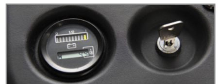
Batteriestandanzeige, Betriebsstundenzähler, Schlüsselschalter und Notaus serienmäßig.
