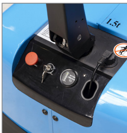
Ausgestattet mit CURTIS-Batteriestands-Ladeanzeige mit Betriebsstundenzähler
