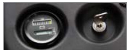
Batteriestandanzeige, Betriebsstundenzähler, Schlüsselschalter und Notaus serienmäßig.
