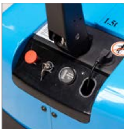
Ausgestattet mit CURTIS-Batteriestands-Ladeanzeige mit Betriebsstundenzähler
