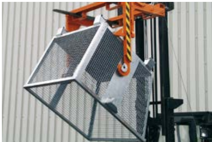
Gitterbehälter Typ BSK-G 90 mit Traverse Typ BST-20
